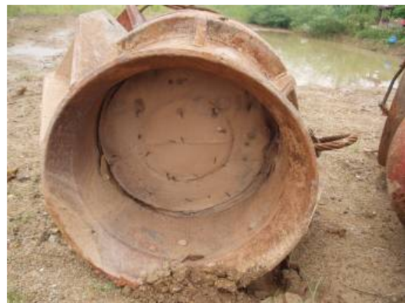
照片4 樁墊材料檢查或更新裝設
